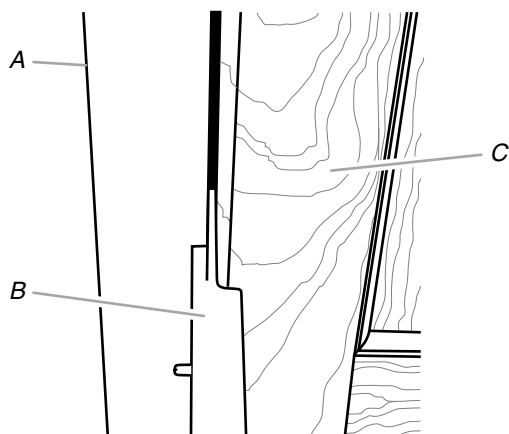
A. Armario adyacente B. Bloque de instalación C. Panel sobre la puerta
