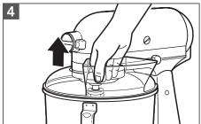
提起导流罩的前部,离开桶边缘,并将其向前拉动。拆下附件和桶。
